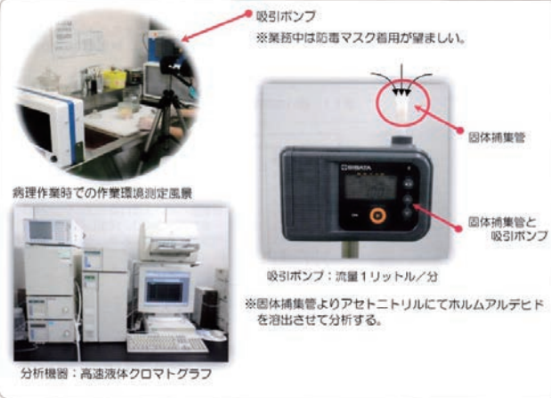
図14 気中ホルムアルデヒド濃度の作業環境測定と分析機器
